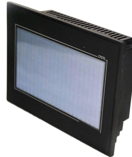
Рис.6. Панель управления насосными станциями
